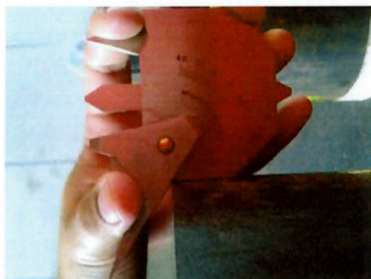
Figura 4.2 – Detalhe do ângulo do chanfro
