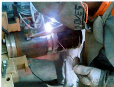
Figura 4.4 – Soldagem tubo ASTM A335 Gr P11 processo TIG posição 1G – girando
